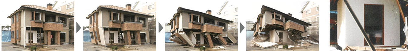
実験状況 ※上写真の2階建て建物は破壊実験を目的としていることから、耐力壁を大幅に撤去するなど、あえて強度を低下させた仕様になっています。
