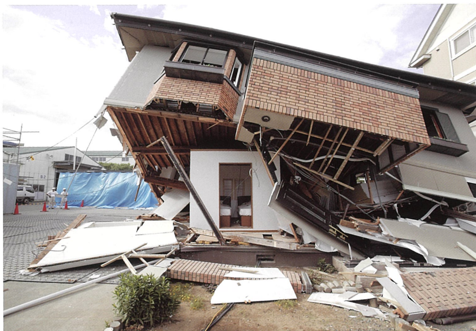
倒壊実験後のシェルター外観
