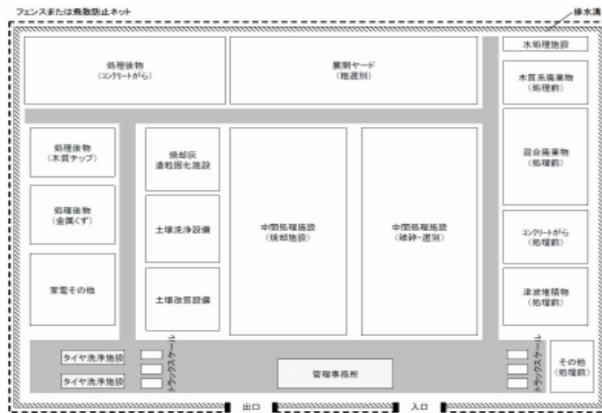
図7-2 二次仮置場の配置レイアウト例
