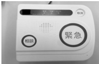
固定型の緊急通報装置本体
