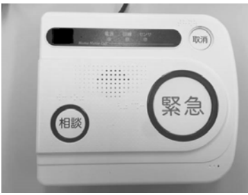
固定型の緊急通報システム本体
