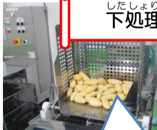
球根皮むき機という機械でじゃがいもの皮をむきます。この後、手作業でじゃがいもの芽取りをし、料理に合わせた大きさに切ります。
