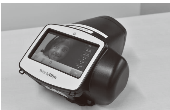
手持ち自動判定機能付きフォトスクリーナー装置 【写真提供 / 千葉県船橋市】
