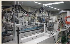
貼り加工機、サックマシンの1つ。製品ごとに細かく設定を変え、正確な糊付けを行う。糊付け状態や紙の折れ具合をコンピュータで管理。
