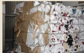
製紙会社で新たな資源へリサイクルされる圧縮された紙片。専用コンベアで1か所に集約、圧縮し、ワイヤーで固定するまでの全ての工程を自動化。
