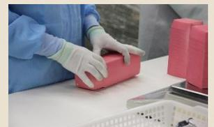
2021年に設置したクリーンブースにより食品一次容器の製造が可能に。入り口にはエアシャワーを設置し、専門スタッフは専用の作業着を着用し、衛生管理を徹底。
